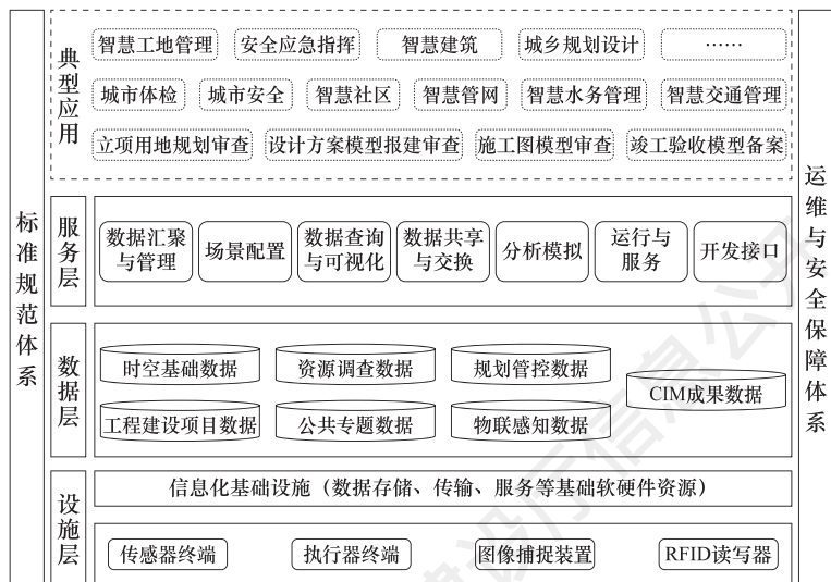
图 3.0.1-2 市级 CIM 基础平台总体架构
