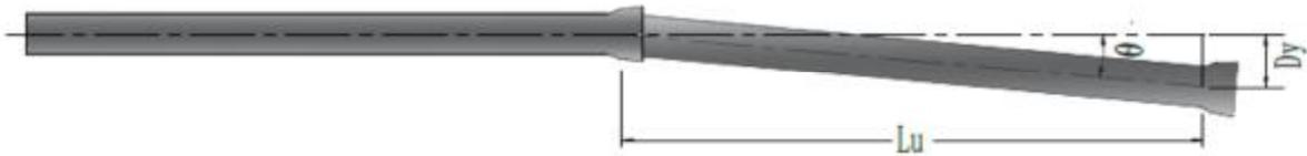
图 4.2.8 滑入式柔性接口最大允许转角与对应的端部位移示意图
